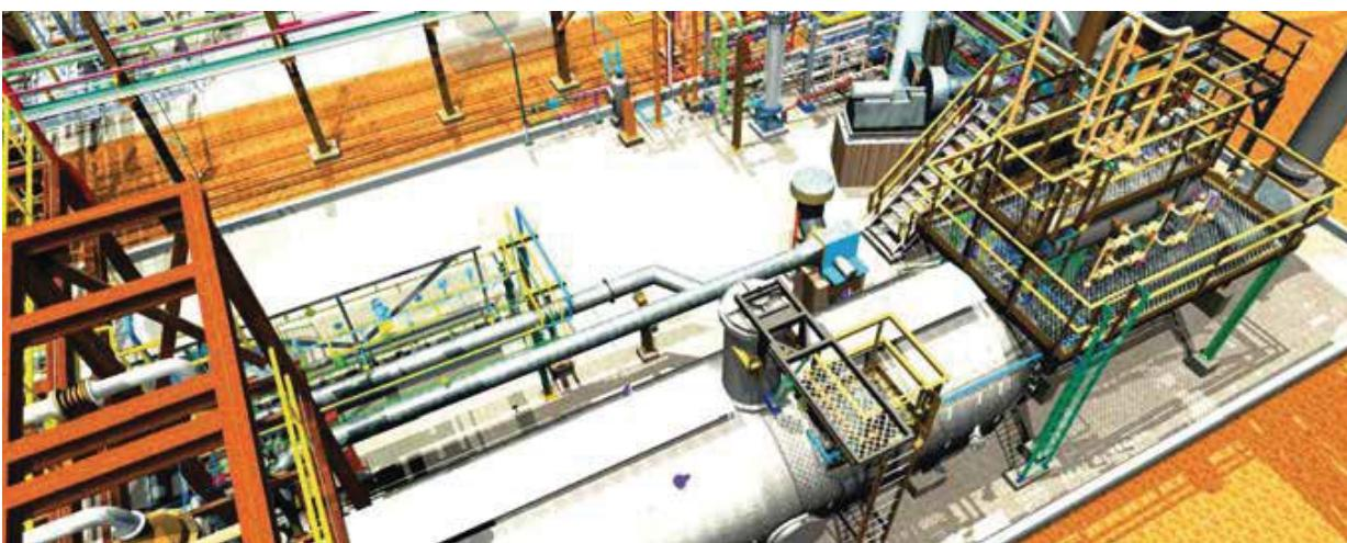
Como punto fundamental de la ingeniería, cabe destacar que el nuevo Incinerador, debido a la temperatura que desarrolla, presenta un desplazamiento longitudinal en el apoyo móvil del mismo, el cual coincide con el extremo en el cual acometen las cañerías principales de gases a ser quemados.
